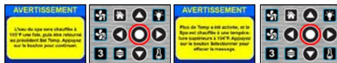
Touchez Sélectionner à nouveau pour confirmer votre température programmée. Touchez Sélectionner à nouveau pour effacer le dernier message d'avertissement, et votre température limite sélectionnée sera enregistrée dans le journal d'événements. L'eau sera chauffée à la température sélectionnée une seule fois. Vous devrez revenir dans le menu Température limite pour l'augmenter à nouveau au-delà de 104°F (40.0°C).
