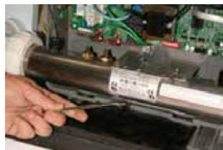
**ÉTAPE 7** - Dévissez les deux écrous de verrouillage de supports sur le tube a l'aide de la clé 3/8
