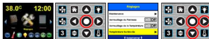
Pour augmenter la température limite de l'eau à 105°F (40.5°C) ou 106°F (41.0°C), dans le mode navigation, lorsque Réglages est surligné, touchez Sélectionner pour ouvrir le menu Réglages. Faites défiler vers le Bas, et lorsque Température limite est surligné, touchez Sélectionner ou Droite pour ouvrir le menu Température limite.
