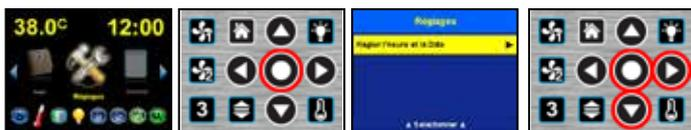
Pour régler l'heure et la date, dans le mode navigation, lorsque Réglages est surligné, touchez Sélectionner pour ouvrir le menu Réglages. Faites défiler vers le Bas, et lorsque Régler l'heure et la date est surligné, touchez Sélectionner ou Droite pour ouvrir le menu Régler l'heure et la date.
