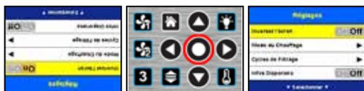
Pour remettre l'écran et les boutons à l'endroit, dans le menu Réglages lorsque la barre de menu inverse l'écran est surlignée, touchez à nouveau Sélectionner pour remettre à l'endroit l'écran et les boutons.
