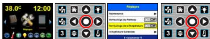
Pour activer le verrouillage de la température, dans le mode navigation, lorsque Réglages est surligné, touchez Sélectionner pour ouvrir le menu Réglages. Faites défiler vers le Bas, et lorsque Verrouillage de la température est surligné, touchez Sélectionner pour verrouiller la température de l'eau.
