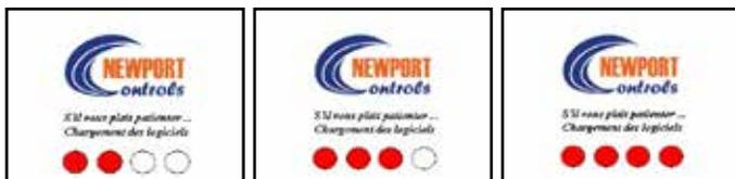
Il faut en général 3 à 4 minutes pour charger le logiciel et initialiser le système de commande. Une fois sous tension, le rétroéclairage du bouton du panneau de commande s'allumera, mais l'écran restera noir pendant environ 20 secondes. Ensuite, s'affichera pendant les 20 secondes suivantes une liste des numéros de série et de pièces. Environ 40 secondes après la mise sous tension, un écran indiquera que le logiciel est en cours de chargement.
