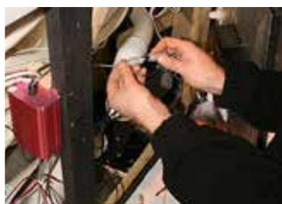
**ÉTAPE 2** - Dévisser l'écrou puis débrancher la connexion de l'amplificateur
