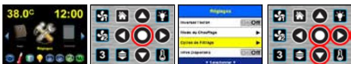
Pour configurer les cycles de filtrage, dans le Mode navigation, lorsque Réglages est surligné, touchez Sélectionner pour ouvrir le menu Réglages. Faites défiler vers le Bas, et lorsque Cycles de filtrage est surligné, touchez Sélectionner ou Droite pour ouvrir le menu Configurer les cycles de filtrage.
