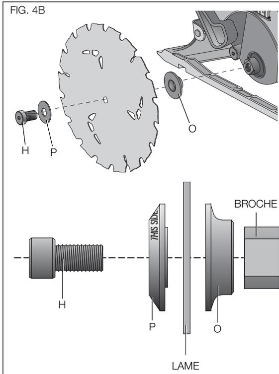
4. Fileter la vis de fixation de la lame (H) dans la broche et la serrer fermement avec les doigts (cette vis à filetage inverse doit être serrée vers la gauche).
