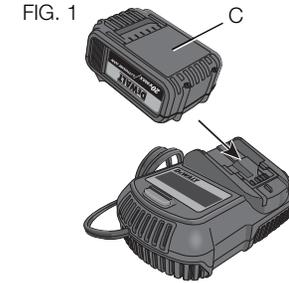
3. La luz roja se quedará ENCENDIDA continuamente cuando se haya completado el proceso de carga. La unidad estará entonces completamente cargada y podrá ser utilizada de inmediato o dejarse en el cargador.
