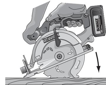
Un corte central es un corte realizado en un piso, una pared u otra superficie plana.
