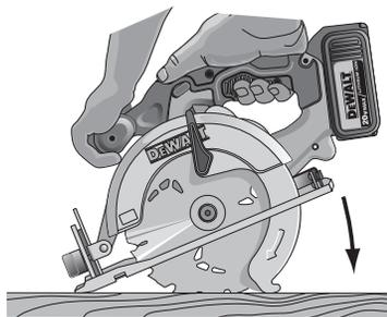
6. Démarrer le moteur et baisser graduellement la scie jusqu'à ce que le patin repose à plat sur la surface. Faire avancer la scie le long de la ligne de coupe jusqu'à ce que cette dernière soit terminée.
