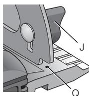
3. Afloje el botón de ajuste del bisel (J). Coloque una escuadra contra la hoja y la base para ajustar la configuración de 90°.
