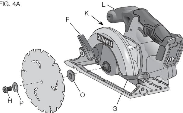
3. Placer la rondelle de bride de serrage externe (P) sur la broche de scie, en s'assurant de placer la large surface plane contre la lame, et le côté biseauté vers l'extérieur.
