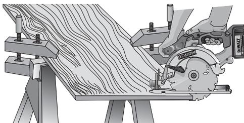
La figure 10 illustre la position de sciage appropriée. Les mains doivent être tenues éloignées de la zone de coupe. **Pour éviter l'effet de rebond**, TOUJOURS soutenir la planche ou le panneau PRÈS de la ligne de coupe (fig. 11), JAMAIS loin de celle-ci (fig. 12).
