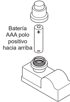
Figura 12 - Instalación de la batería en Ignitor
