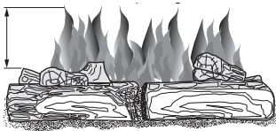
Figura 27 - Patrón incorrecto de la llama del quemador
