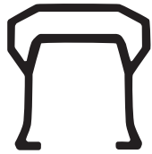
Profil de la rampe supérieure
