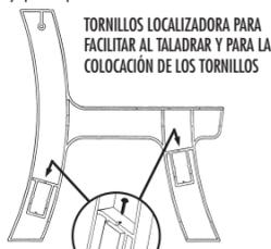
TORNILLOS LOCALIZADORA PARA FACILITAR AL TALADRAR Y PARA COLOCACIÓN DE LOS TORNILLOS
