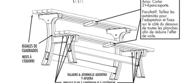
Aviso: Cortar 2x4 para soporte. Facultatif: Taillez les extrémités pour l'adaptation et fixez sur le côté du dessous de toutes les planches afin de réduire l'effet de voile.
