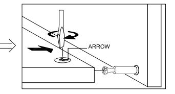
NOTE: • THE ARROWS ON THE HIDDEN CAM-LOCKS SHOULD POINT TO THE CAM-BOLTS.
