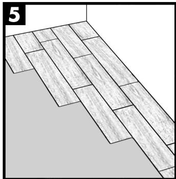
5. Al conectar entre sí una unión corta y una larga (tablón núm. 3 a núm. 1 y núm. 2), conecta el lado largo del tablón núm. 3 al núm. 1 y desliza el lado corto del tablón núm. 3 al ras del lado corto del tablón núm.
