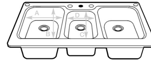
DEPTH 9" (229mm)      DEPTH 7 1/2" (191mm)      DEPTH 9" (229mm)
