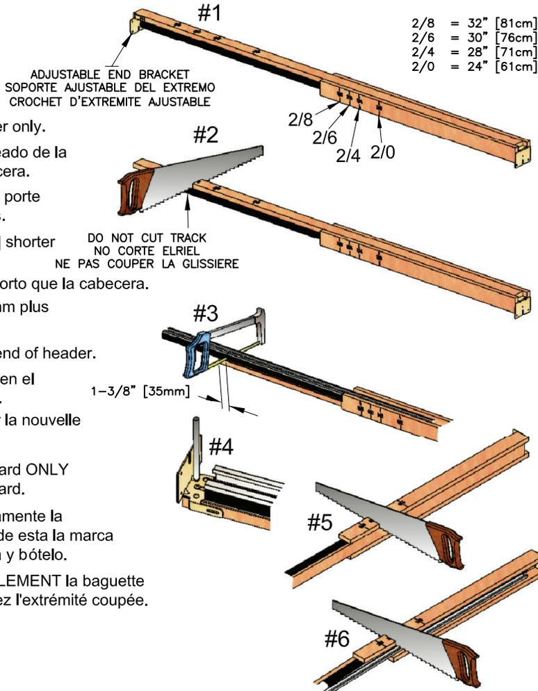
Para cortar la cabecera para puertas que no sean de un ancho estandar: Mida el ancho de la puerta y multipliquelo por 2. Súmele 25mm. Marque la cabecera y córtelo (Paso #2). Corte el riel (Paso #3). Mida el ancho de la puerta. Súmele 25mm. Marque la guía de la tabla del contramarco de la cabecera y córtelo (pasos #5 & #6).
