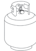
Bouteille en position verticale vers le haut afin de permettre l'évacuation de vapeurs.
