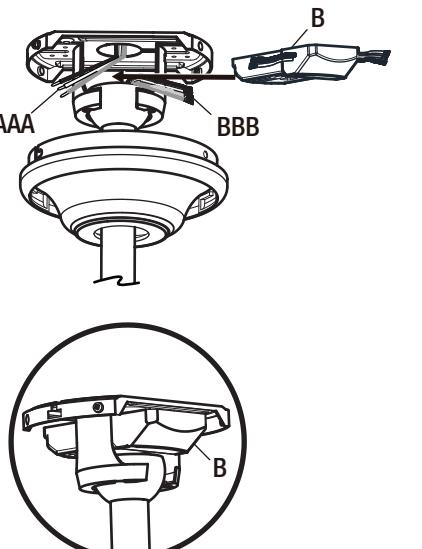
Receptor (B) correctamente colocado en el soporte de montaje.
