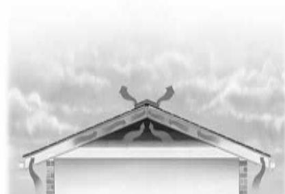
Para calcular el valor mínimo de la ventilación requerida, use las relaciones 1/300 ó 1/150. En las páginas interiores, hemos realizado los cálculos necesarios para su comodidad. Use la relación 1/300 si tiene una distribución correcta de aberturas de ventilación en el soffit y capotes ventilados en la cumbre o si cuenta con un retardador de vapor. Use la relación 1/150 si no puede obtener una distribución correcta de ventilación y no dispone de un retardador de vapor.
