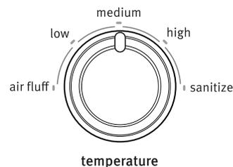
Sélectionner la température en tournant le bouton à la position désirée ou sélectionner le programme de séchage par détection dont la température figure dans les sélections de programme. Tourner le bouton TEMPERATURE (température) pour modifier le réglage de la température de séchage. Voir "Réglage de la température de séchage".
