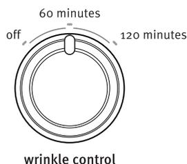
Sélectionner l'option Wrinkle Control (anti-froissement) en tournant le bouton à la position souhaitée.
