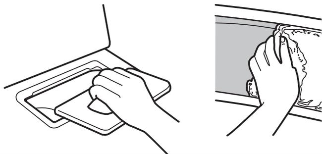
Nettoyer le filtre à charpie avant chaque charge. Tirer le filtre à charpie de son support. Enlever la charpie du filtre en la roulant avec les doigts. Ne pas rincer ni laver le filtre pour enlever la charpie. Remettre le filtre à charpie fermement en place.
