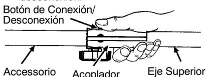
3. Mientras sostiene el motor y el eje superior con firmeza, quite el accesorio del acoplador en forma recta.
