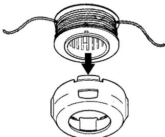
10. Insérez le bouts de fil dans les trous de sortie situés sur la couverture.
