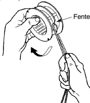
7. Avec votre doigt entre les fils, enroulez le fil bien serré et uniformément sur la bobine, dans un sens horaire.
