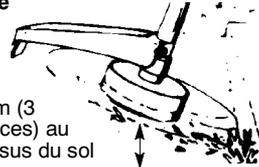
**RASAGE** - La technique de rasage retire toute végétation non désirée. Maintenez le bas de la tête de coupe à environ 8 cm (3 pouces) du sol et à un angle. Permettez à la pointe du fil de frapper le sol autour des arbres, des piquets, des monuments, etc. Avec cette technique, le fil s'use plus vite.
