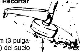
**PARA ESCALPAR** - La técnica del escalarpa retira la vegetación no deseada abajo a la tierra. Sostenga el cabezal unos 8 cm (3 pulgadas) del suelo y en ángulo. Deje que la punta de la línea golpee contra el suelo cerca de los árboles, los postes, los monumentos, etc. Esta técnica incrementa el desgaste de la línea.
