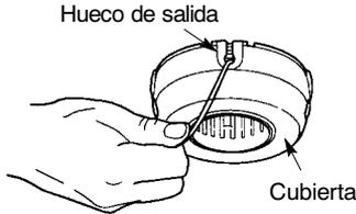
11. Coloque la bobina y la cubierta en el cabezal de corte. Empuje hasta que la cubierta se encaje en su lugar.
