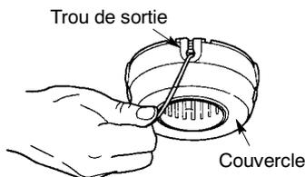
11. Ré-installez la bobine et le couvercle sur la tête de coupe. Poussez jusqu'à ce que la couverture soit bien bloquée en place.
