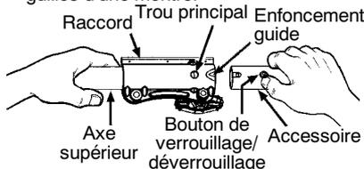
**AVERTISSEMENT:** Assurez-vous que le bouton de verrouillage/déverrouillage soit bien verrouillé dans le trou principal et que le bouton soit bien en place avant de faire fonctionner votre appareil. Tous les accessoires sont conçus pour être utilisés dans le trou principal à moins que le manuel d'instruction de l'accessoire indique le contraire. Utiliser le mauvais trou peut amener des blessures graves ou endommager votre appareil.
