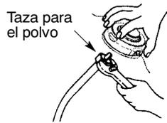
2. Remueva el cabezal de corte dando vuelta a la izquierda (mirando desde la base del aparato).
