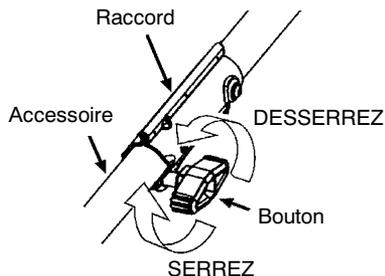
2. Appuyez sur le bouton de verrouillage/déverrouillage et maintenez-le appuyé.
