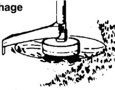
**BALAYAGE** - Vous pouvez utiliser l'action de balayage du fil de coupe pour nettoyer vite et facilement. Maintenez le fil parallèle aux sur-
