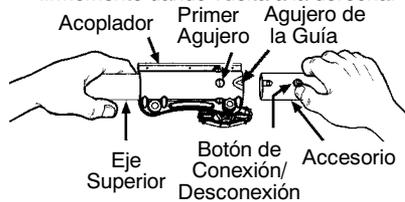
**⚠ ADVERTENCIA:** Antes de operar este aparato, asegúrese de que el botón de conexión/desconexión esté asegurado en el primer agujero y la perilla esté bien ajustada antes de operar el aparato. Todos los accesorios han sido diseñados para ser utilizados en el primer agujero a menos que esté indicado de otra manera en el manual de instrucción aplicable del accesorio. Usar el agujero incorrecto podría causar graves heridas o daños a el aparato.
