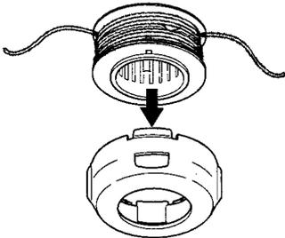
10. Introduzca la puntas de las líneas dentro de los huecos de salida en la cubierta.
