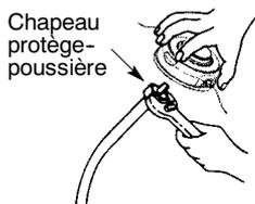
2. Enlevez la tête de coupe en tournant dans le sens contraire des aiguilles d'une montre (vu depuis le bas de l'appareil).
