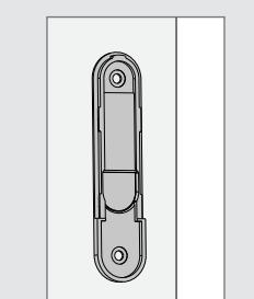
Deslice la base sobre el soporte ya montado.
