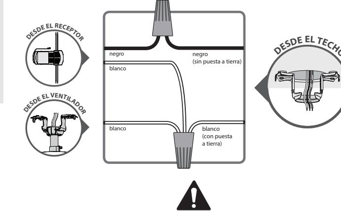
Gire los empalmes hacia arriba y presínelos cuidadosamente hacia atrás a través del soporte de suspensión dentro de la caja de salida. Separe los alambres, con los alambres puestos a tierra a un lado de la caja de salida y los alambres no puestos a tierra al otro lado de la caja de salida.
