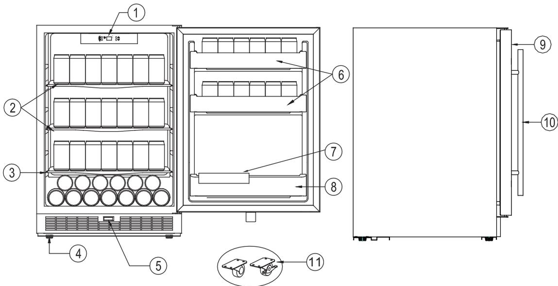
1. **Panneau de commande** : permet de voir et de régler la température du tout réfrigérateur
