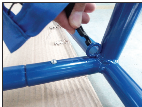
5. Fixez les crochets aux coins inférieurs du filet aux anneaux des pattes inférieures (B).
