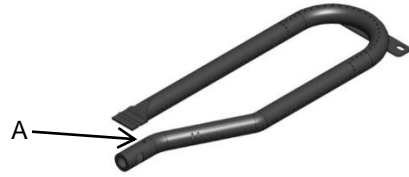
A. Vis de réglage de l'admission d'air
