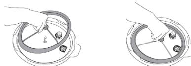
**Nota:** Si la junta no está colocada correctamente, la unidad no generará presión. La junta de silicona siempre debe estar colocada correctamente. Verifique periódicamente para asegurarse de que esté limpia, sea flexible y no esté agrietada o rota.
