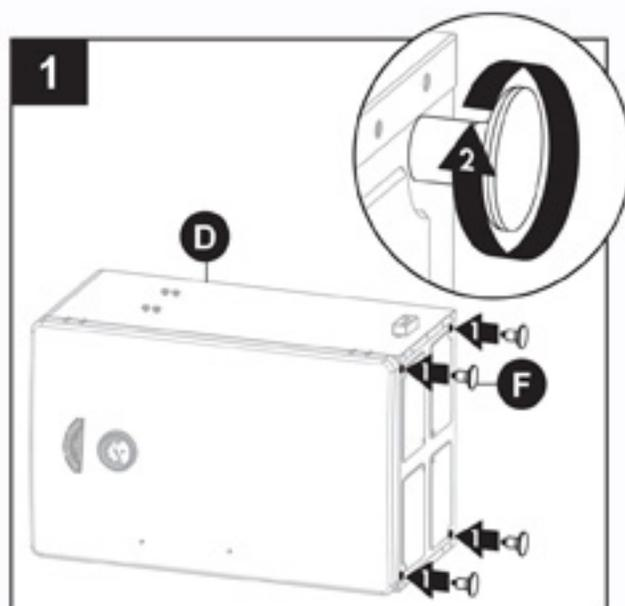
2. Coloque el gabinete (D) erguido con cuidado. Nivele el gabinete (D), para esto coloque un nivel (no se incluye) en el lado del gabinete (D) y ajuste las patas (F) hasta que se nivele.
