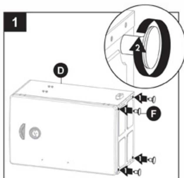
2. Avec précaution, remettez le fumoir (D) debout. Mettez le fumoir (D) de niveau en plaçant un niveau (non inclus) sur le côté du fumoir (D) et en ajustant les pieds (F) jusqu'à ce qu'il soit de niveau.
