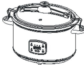
Empuje hacia atrás los clips en posición para bloquear y sellar la tapa.
