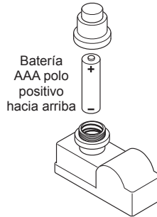
Figura 20 - Instalación de la batería en Ignitor
