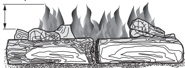
Figura 24 - Patrón correcto de la flama del quemador
