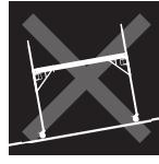
UNIT SHALL ONLY BE USED ON FIRM AND LEVEL SURFACES
