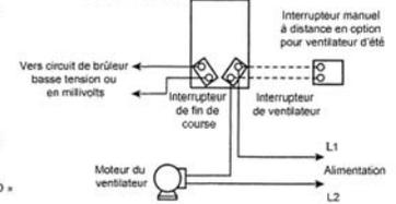
**Schéma avec utilisation d'une limite dans un circuit basse tension ou en millivolts**
