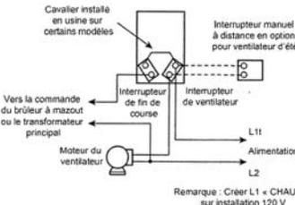
**Schéma avec utilisation d'une limite dans un circuit de ligne électrique**
