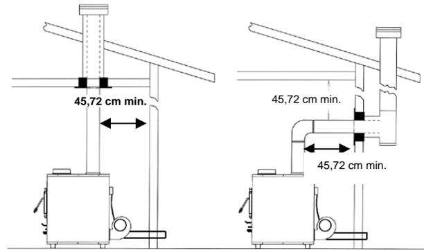
**Figure 2 – Installation dans un système de conduit de fumée de type HT
