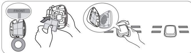
Après avoir changé le filtre d'air, appuyer pendant trois secondes sur le bouton du Filtre d'air pour réinitialiser le capteur du filtre.
