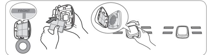
Luego de cambiar el filtro, mantenga pulsado el botón Air Filter durante tres segundos para restablecer el sensor del filtro.
