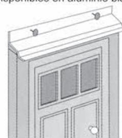
Nota: Recuerde que debe clavar debajo del tejado y que debe utilizar clavos adecuados – clavos para aluminio con los bordes de aluminio y clavos galvanizados con los bordes galvanizados.
