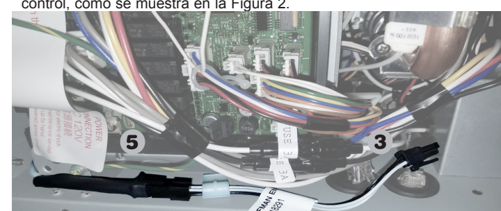
Figure 2. - Cree un lazo en el lado izquierdo del calentador de agua a gas sin tanque que pase a través de la parte trasera de la entrada y la salida de agua y concluya con la punta del sensor en la parte inferior derecha del calentador de agua, como se muestra en la Figura 3.
