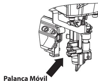
Inspeccione la palanca móvil en la nariz para funcionamiento propio.
