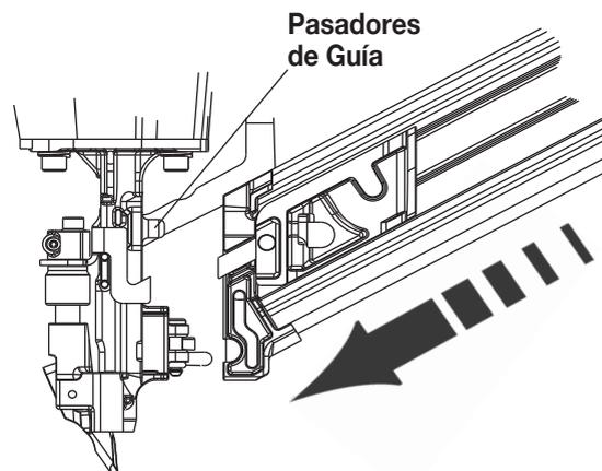
3. Deslice el cargador adelante insertando los pernos de guía de la nariz con los orificios de montaje en el cargador.
