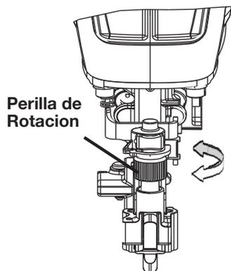
Gire la perilla hacia la izquierda para disminuir la profundidad de sujetador.
