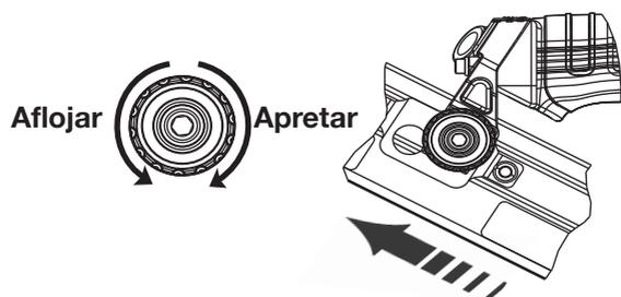
3. Deslice el cargador en el soporte de montaje hasta el frente de el cargador libere los pernos de guía ubicado en la nariz. Pivote o remueva el cargador para la inspección.
