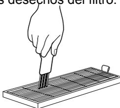
5. Su canasta de filtro se puede lavar. Límpiela solo con agua y deje secar al aire antes de volver a instalarla en el robot.
