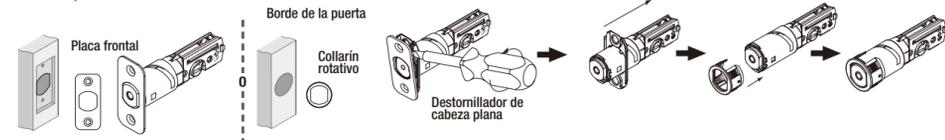
B. Coloque la entrada del cerrojo El seguro está diseñado para una distancia de ajuste de 2-3/8". Si es necesario, puede ajustarse a 2-3/4" (omita esto si su puerta cuenta con una distancia de ajuste de 2-3/8")
