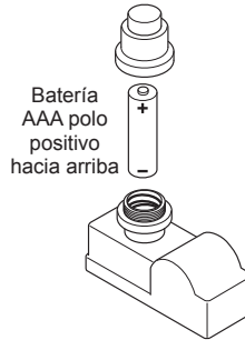
Figura 15 - Instalación de la batería en Ignitor
