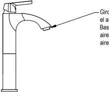
Giro abra la tapa del aireador hacia la izquierda para quitar el aireador. Va a encontrar un aireador instalado aquí. Basta con quitar el aireador 1.2 gpm y reemplazarlo con el aireador 1,5 gpm (siempre). Vuelva a colocar la cubierta del aireador girándolo en sentido horario.
