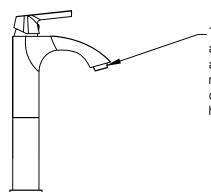
Twist ouvrir le couvercle de l'aérateur dans le sens antihoraire pour retirer l'aérateur. Vous trouverez un aérateur installé ici. Il suffit de retirer l'aérateur 1,2 gpm et le remplacer par l'aérateur 1,5 gpm (fourni). Replacer le couvercle de l'aérateur en le tournant en arrière sur le sens horaire.
