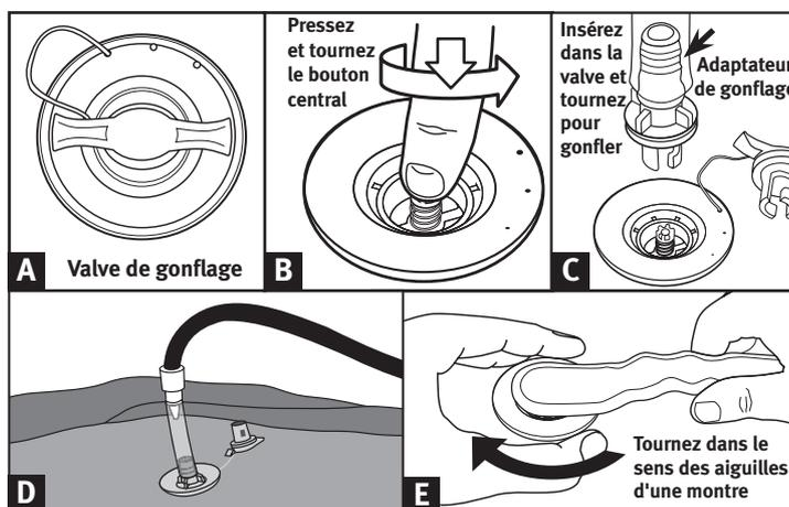
Serrez sans forcer la valve à l'aide de la clé de gonflage. **NE PAS TROP LA SERRER.**
