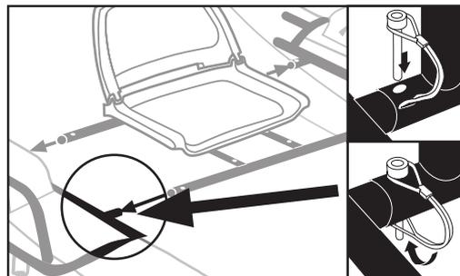
▲ Insérez les axes d'épaulement sur le côté du cadre et non pas entre la chambre à air et le cadre afin d'éviter de déchirer le ponton.
