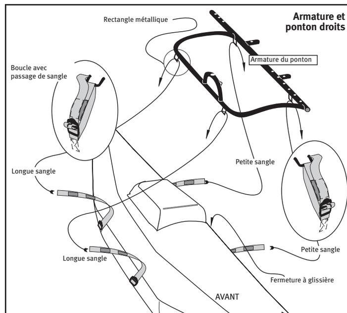
À présent, attachez les deux sangles intérieures et les deux sangles extérieures du ponton à l'armature du ponton. Enfilez les sangles de la façon suivante:
