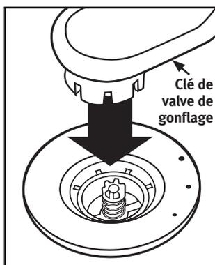
S'il s'avère difficile de tourner la valve, retirez complètement la valve et ajoutez une petite quantité de graisse à base de silicone sur le joint torique de la valve et remontez les pièces.
