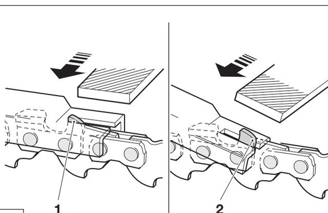
A la suite du nouvel affûtage, vérifier la hauteur du limiteur de profondeur avec la jauge de mesure pour chaîne. Voir accessoires pour le n° de commande.
