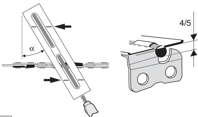
Un porte-lime facilite le guidage de la lame, il porte des repères pour l'angle d'affûtage correct de:
