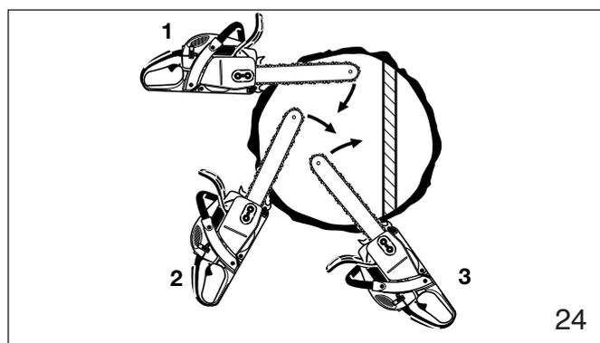
Pour la méthode de sectionnement (fig. 24), pratiquez la première coupe en faisant pivoter le guide vers le tenant. Ensuite, en utilisant la griffe du butoir comme un pivot, repositionnez la tronçonneuse pour la coupe suivante. Évitez de repositionner la tronçonneuse plus que c'est nécessaire.
