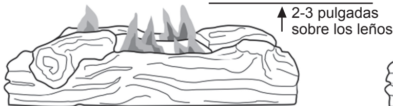
Fig. 22 - Patrón correcto de la llama del quemador
