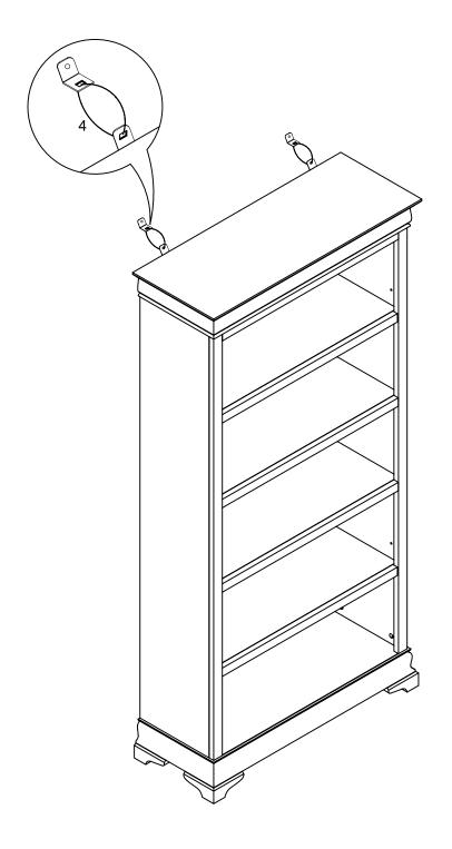
• USING THE PLASTIC BAND (4) CONNECT TWO RECTANGLE METAL PLATES (1).
