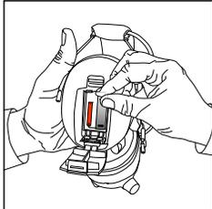
Para comenzar, inserte la primera batería en la parte inferior. Presiónela para ajustarla.
