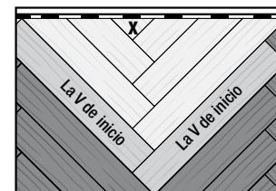
Si terminas el piso con pequeños pedazos triangulares (ver tablón X), coloca una gota de «pegamento instantáneo» (adhesivo de cianoacrilato) en la ranura antes de golpear sobre el tablón. Elimina cualquier resto de adhesivo lo más rápido posible usando alcohol minerales.
