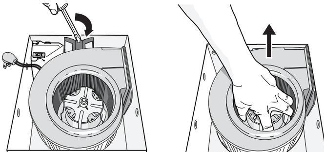
**2. Retire el panel de cableado de la cubierta del ventilador.**
