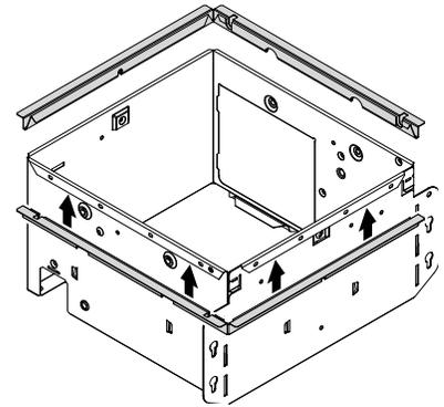
**4. Acople los soportes de la rejilla a la cubierta.**
