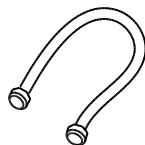
Línea de suministro de agua del inodoro
