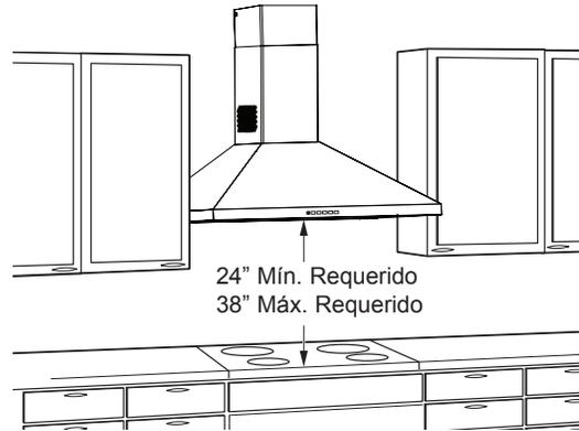
La campana de ventilación debe ser instalada entre el mínimo requerido de 24" y el máximo recomendado de 38" sobre la superficie de cocción. La altura de instalación de la campana sobre la superficie de cocción depende de la altura del cielorraso y las limitaciones de la cubierta del conducto. La cubierta plegable oculta los conductos que van desde la parte superior de la campana hasta el cielorraso. Para las alturas de cielorraso de las cubiertas de conductos, consulte la tabla de la página 5.
