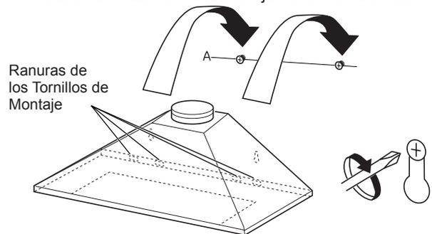
2. Inserte 2 tornillos de montaje en los 2 sostenes de la cubierta del conducto (instalados en la línea D en la sección de **Preparación de la Pared**), ubicados en las ranuras de la superficie trasera de la campana. Ajuste de manera firme.
