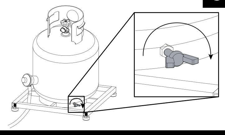
Avec le réservoir de propane bien en place et le tuyau régulateur branché, mettre le couvre-réservoir (1) sur la base (2).
