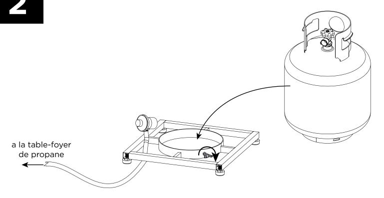
Mettre le réservoir de propane dans la base et fixer bien en place le réservoir en serrant la vis au bas de la base.
