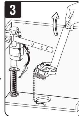
Retire la empaquetadura que une el tanque con la taza y la tuerca grande de la válvula para descarga de inodoro antigua. Luego retire la válvula para descarga de inodoro del tanque.
