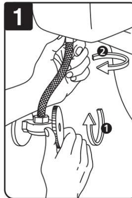
Corte el suministro de agua (1). Descargue el inodoro y retire el exceso de agua del tanque con una esponja. (2) Coloque una cubeta o una toalla bajo la tubería de suministro de agua y retire la tuerca de la tubería de suministro de agua de la parte inferior de la válvula de llenado del inodoro.
