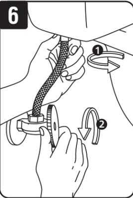
Vuelva a conectar la tubería del suministro de agua en la parte inferior de la válvula de llenado (1). Abra el suministro de agua y revise si hay fugas. Si hay fugas, gire la tuerca sólo lo suficiente para evitar fugas. Luego, descargue el inodoro para verificar.
