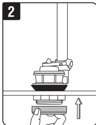
Coloque la empaquetadura que une el tanque a la taza nueva sobre la tuerca, con el lado angosto hacia abajo. La empaquetadura debe cubrir completamente la tuerca.
