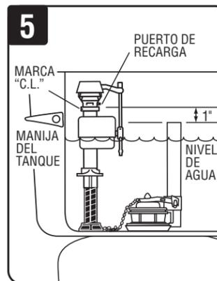
Cuando instale el tubo de desborde de la válvula para descarga de inodoro, la parte superior de éste debe estar al menos 7,62 cm por debajo de la parte superior de la válvula de llenado.
