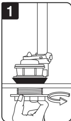
Coloque la válvula de descarga en el tanque. Coloque el tubo de desborde hacia la parte posterior del tanque. No cubra los orificios de los pernos. Ajuste la contratuerca de la válvula para descarga de inodoro con la mano. **NO APRIETE DEMASIADO**, de lo contrario el tanque se puede agrietar.
