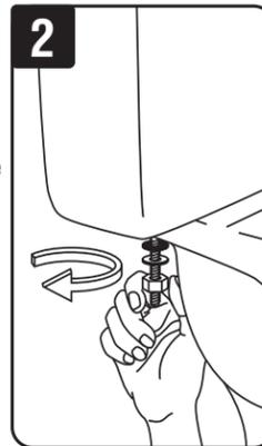
Destornille el tanque de la taza, luego levante el tanque y póngalo sobre una superficie estable y suave. Retire cualquier arandela de goma restante, la tuerca hexagonal y los pernos.
