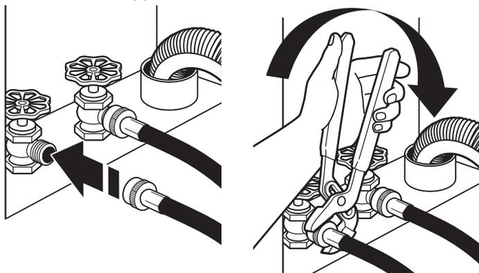
**REMARQUE :** Ne pas serrer excessivement ou utiliser du ruban adhésif ou un calfeutrant sur la valve. Les valves risquent d'être endommagées.
