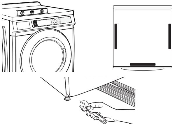
Si la laveuse est placée contre un mur, on doit l'écartier légèrement du mur avant de l'incliner vers l'arrière. Si la laveuse n'est pas d'aplomb, soulever l'avant de la laveuse avec une cale de bois et ajuster la position des pieds selon le besoin; soulever ensuite l'arrière de la laveuse et ajuster la longueur des pieds selon le besoin. Répéter ces opérations jusqu'à l'obtention d'un aplomb correct de la laveuse.
