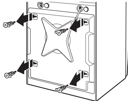
4. Une fois que les 4 boulons ont été retirés, jeter les boulons et les cales d'espacement. Puis pousser la fiche du cordon d'alimentation électrique à travers l'ouverture sur le côté droit du panneau arrière, tirer le cordon d'alimentation électrique à travers l'ouverture sur le côté gauche du panneau arrière et obturer les trous avec le bouchon fourni. Ne pas tirer l'extrémité du cordon d'alimentation à travers le trou de droit.
