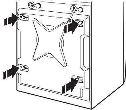
3. Une fois le boulon desserré, le déplacer au centre du trou et retirer complètement le boulon, y compris la cale d'espacement en plastique couvrant le boulon.
