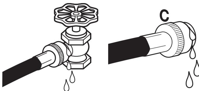
**REMARQUE :** Remplacer les tuyaux d'arrivée d'eau après 5 ans d'utilisation pour réduire le risque de défaillance. Prendre note de la date d'installation ou de remplacement des tuyaux, pour référence ultérieure.
