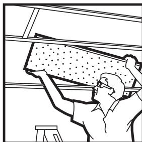
**12.** Poser les panneaux de plafond — Il est plus facile de commencer dans un coin de la pièce et d'installer les panneaux une rangée à la fois. Faire glisser chaque panneau par l'ouverture et le baisser de façon à ce qu'il s'appuie sur les quatre traverses. Note : les flèches à l'endos du panneau doivent toutes pointer dans la même direction !
