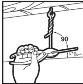
**8. Doble retorciendo los cables de suspensión — Utilice los alicates para doblar a un ángulo de 90° en todos los cables de suspensión a una distancia de 3/4 de pulgada (19 mm) por encima de la cuerda. Si el agujero de suspensión más cercano no se encuentra directamente debajo de la armella rosada, ajústelo apropiadamente.**
