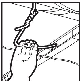
**10.** Suspender les profilés — Faire passer chaque fil métallique à travers le trou de suspension dans le profilé. Après avoir vérifié la ligne de la ficelle pour s'assurer que le profilé est à niveau, tordre le fil vers le haut sur lui-même plusieurs fois pour une bonne attache solide.
