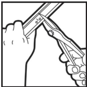
El corte de las piezas en T resulta más fácil con tijeras de mano para metales. Primero, corte el borde saliente y, luego, doble la pieza en T alejándola del corte y recorte el resto. Recorte o pula las rebabas y bordes ariscos. Si no dispone de tijeras de mano para metales, utilice una sierra para metales para serrar desde la parte superior del borde saliente y, luego, pula la rebaba.
