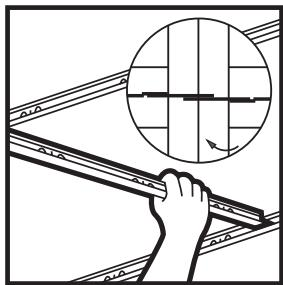
**11.** Instale las piezas en T — Despues de que las piezas en T principales estén colgadas, instale las piezas en T cruzadas. Empuje el extremo de la pieza en T cruzada a través de la ranura de la pieza en T principal hasta que se escuche un "clic". Allí donde dos piezas en T interseccionen en la misma ranura, asegúrese de insertar la segunda unión a la izquierda de la primera.
