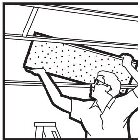
**12.** Coloque los paneles de cielo raso — Resultará más fácil si comienza por una esquina de la habitación y si instala los paneles de fila en fila. Incline cada panel hacia arriba a través del hueco y, luego bájelo hasta que rebose centrado en las cuatro piezas en T. Nota: todas las flechas que aparecen en la parte posterior de los paneles deberán apuntar en la misma dirección.
