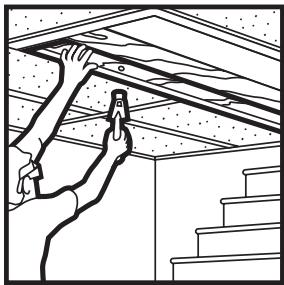
Si une fenêtre ou une cage d'escalier se prolonge au-dessus du plan du plafond, construire une cantonnière avec 3/4 po (19 mm) de bois. La fixer aux murs et aux solives ou à l'ancien plafond. Fixer les cornières murales à la cantonnière comme s'il s'agissait d'un mur.
