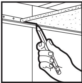
Découpe de la ligne d'ombre sur le côté : après avoir découpé le panneau à la bonne taille, l'ajuster dans le quadrillage en mettant le bord coupé vers le mur. Dessiner une ligne sur la face du panneau à l'endroit où il croise la cornière murale. Découper la ligne de front à une profondeur qui coïncide avec la profondeur du renforcement de la ligne d'ombre. Puis, découper à partir du bord du panneau pour découper la bonne profondeur.
