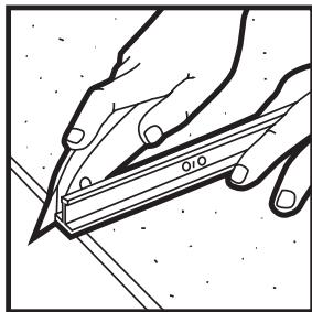
Para cortar un panel, sitúelo sobre una superficie plana con la parte acabada hacia arriba.
