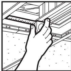
Para hacer la instalación sorteando un obstáculo como, por ejemplo, un poste o un panel de ventilación, dibuje su ubicación exacta en el panel y haga el corte con el cuchillo para todo uso. Para acoplar un panel sobre tuberías, corte dos lados opuestos e instale el panel en dos partes.
