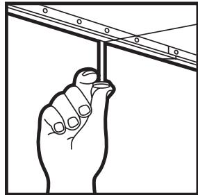
**5. Ubique las piezas en T principales — Extienda una cuerda a través de la habitación a la altura del cielo raso para así poder ubicar cada pieza en T principal. Para hacer esto, ponga tensión en la cuerda tirándola en los clavos insertados entre la pared y el recodo de pared ubicados en paredes opuestas.**
