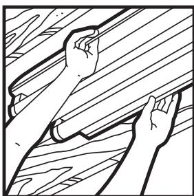
Installer tous les plafonniers et les fils avant le plafond. Suspender les néons aux solives ou au vieux plafond, et jamais au quadrillage du plafond à moins qu'on n'ajoute davantage de fils de suspension pour renforcer la structure de support.
