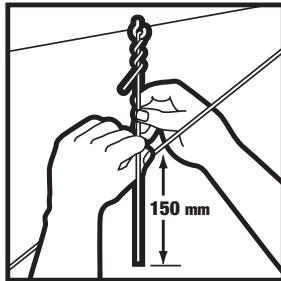
**7. Instale los cables de suspensión — Instale las armellas rosadas con los cables de suspensión enganchados, cada 4 pies (1220 mm), a lo largo de las líneas de la cuerda de las piezas en T principales. Los cables deberán extenderse 6 pulgadas (150 mm) por debajo de la línea de la cuerda.**
