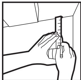
**1. Elija la altura del cielo raso — Instale el cielo raso a cualquier nivel, siempre que deje una distancia suficiente (se recomienda una distancia de 3 pulgadas o 75 mm) por debajo del conducto de aire, tubería o viga más bajos para la instalación de los paneles. Marque la altura deseada en cada esquina de la habitación.**
