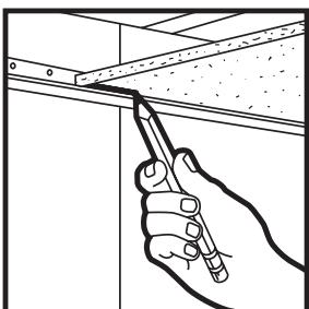
Recorte del borde la línea de sombra: Despues de cortar el panel a la medida, ajustelo en el reticulado de cielo raso con el borde cortado orientado contra la pared. Trace una línea en la cara del panel que intersecciona con el recodo de pared. Haga un corte frontal en la línea que coincide con la profundidad del rebaje de la línea de sombra. Una vez hecho esto, corte hacia dentro desde el borde del panel para recortar la profundidad adecuada.
