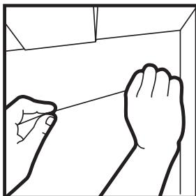
**2. Marque el perímetro con un cordel entizado — Marque la línea de tiza alrededor de todo el perímetro de la habitación, a 3/4 de pulgada (19 mm) por encima de la altura del cielo raso deseada. Verifíquela con un nivel de carpintero. La medición por sí sola, bien sea desde las vigas o desde el suelo, no es recomendable ya que cualquiera de éstos podría no estar bien nivelado.**
