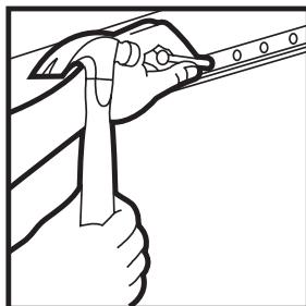
**3. Instale los recodos de pared — Alinee el borde superior del recodo de pared con el cordel entizado y clave los recodos alrededor de toda la habitación. Cláveles a cada montante o travesaño o a intervalos mínimos de 2 pies (610 mm).**
