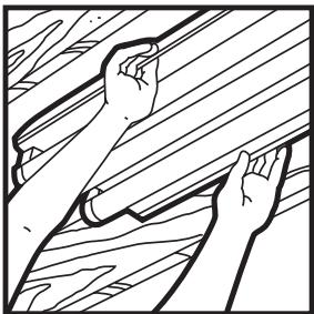
Instale todas las lámparas y el cableado antes que el cielo raso. Suspenda las lámparas fluorescentes de las vigas o del techo antiguo. Nunca del reticulado de cielo raso, a menos que se vayan a añadir cables de suspensión para soporte estructural.
