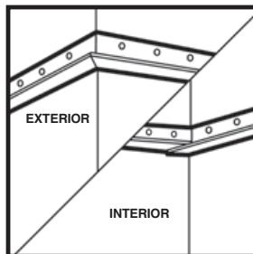
**4. Recorte las esquinas — En las esquinas interiores, recorte los recodos de pared derechos (90°) y acóplelos entre sí. En las esquinas exteriores únalos con inglete (45°) y ajústelos precisamente, o utilice fundas para esquinas.**
