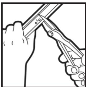
Pour découper les profilés et les traverses avec plus de facilité, utiliser des cisailles. Couper d'abord la tige, puis tordre le profilé dans le sens opposé de la coupe et tailler les rebords. Tailler ou limer les aspérités et les bords rugueux. Si on ne dispose pas d'une cisaille, utiliser une scie à métal pour scier depuis le sommet de la tige, puis limer les aspérités.
