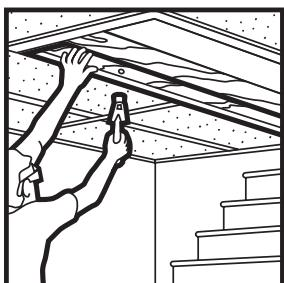
Si una ventana o una escalera se extiende más allá del plano del techo construya un pedazo corto de madera ornamental de 3/4 de pulgada (19 mm). Acópelo a la pared y vigas o al techo antiguo. Fije los recodos de pared a la madera como lo haría a las paredes.
