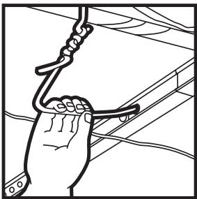
**10.** Cuelgue las piezas en T principales — Tire de cada cable de suspensión a través del agujero de suspensión en la pieza en T. Después de comprobar la línea de la cuerda para asegurarse de que la pieza en T está nivelada, doble el cable hacia arriba y circularmente sobre sí mismo varias veces para asegurar un agarre sólido y apretado.
