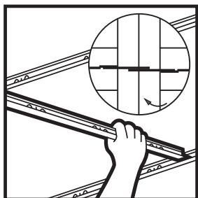
**11.** Installer les traverses — Une fois les profilés posés, installer les traverses. Pousser l'extrémité des traverses dans l'encoche du profilé jusqu'à ce qu'un « clic » se fasse entendre. Dans les endroits où les traverses s'entrecroisent dans la même encoche, s'assurer d'insérer le second profilé à gauche du premier.
