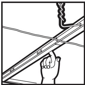
**9.** Alinee las primeras piezas en T — En cada fila, recorte la primera pieza en T principal de la pared de manera que la ranura para la primera fila de piezas en T cruzadas esté alineada con la cuerda. Repose el extremo cortado de la piezas en T principales en el recodo de pared.
