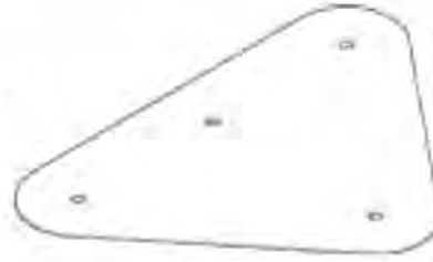
Cale de poutre (x 1) Puntera de la viga (x1)
