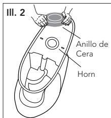
**PRECAUCIÓN:** No mueva el recipiente una vez haya fijado el anillo de cera. Enrosque las tuercas y apriételas igualmente hasta que el inodoro quede ajustado a la brida del suelo. Instale las tapas de los pernos. (ver Ilustración 3). No apriete demasiado las tuercas a los daños a la taza porcelana.
