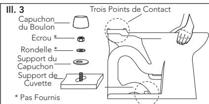
**ATTENTION:** Ne pas bouger la cuvette après avoir fixé le joint en caoutchouc. Posez les écrous et serrez jusqu'à ce que la cuvette soit stabilisée sur la bride. Placez les capuchons des boulons (voir Illustration 3).
