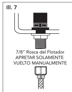
**PRECAUCIÓN:** Evite usar una llave para tubería al apretar la tubería ya que esto podría dañar las roscas plásticas y/o causar que la válvula de llenado rote dentro del tanque.
