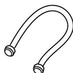
Línea de suministro de agua del inodoro
