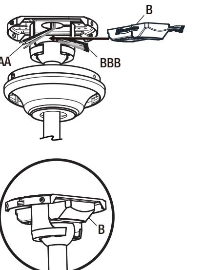
Receptor (B) correctamente colocado en el soporte de montaje.
