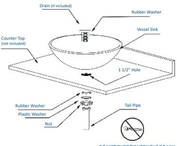
DO NOT OVER TIGHTEN THE DRAIN!
